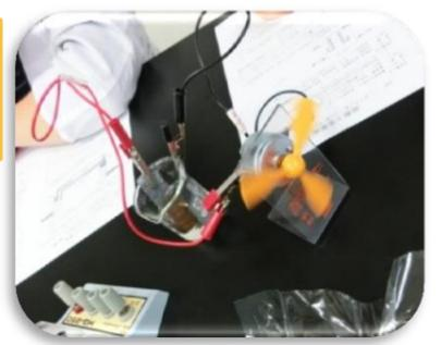
希硫酸に鉛電極版を入れて電流を流すと蓄電されます。水溶液の充電電池でモーターが勢いよく回りましたね。ガソリン車のバッテリーは鉛蓄電池が利用されています。
